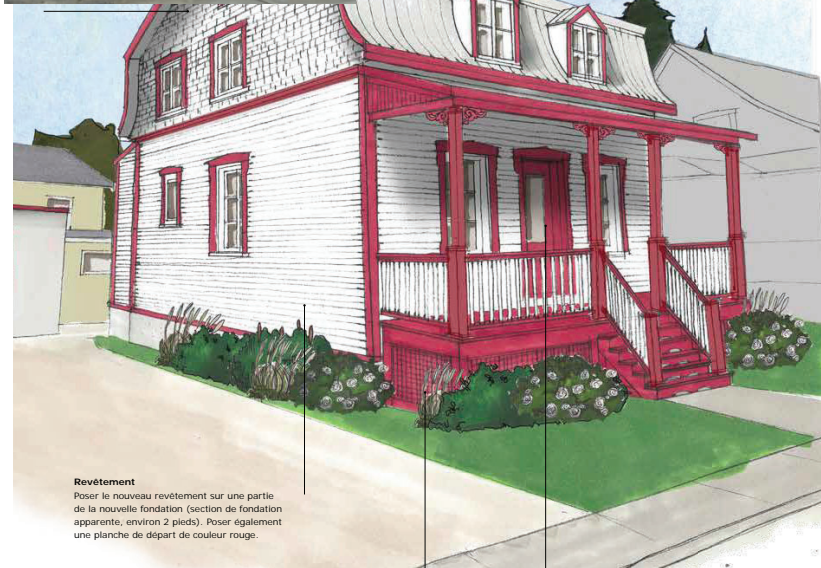
Galerie Surhaussement de la galerie nécessitant un garde-corps. Les poteaux métalliques
